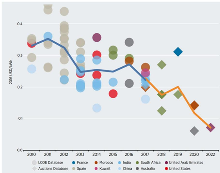
Figure 61: Evolution du LCOE des technologies CSP (source: IRENA)
