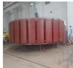
Rotor G4 après montage machines des pôles magnétiques
